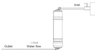
6. Установите прекарбонный фильтр и откройте водоснабжение (кран врезки), чтобы наполнить фильтр и в течение 10 минут не закрывайте воду для промыва самого фильтра. Этим же способом промойте ультрафильтрационную мембрану.
